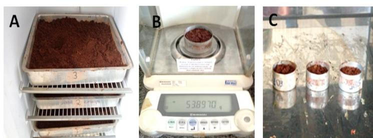
Figura 1 - Tratamento da mistura do solo para realização da análise de biodegradabilidade. A: Recipientes com massa de mistura de solo com baixo teor de argila, areia e esterco bovino; B: Peso da amostra úmida; C: condicionamento em estufa a 25 °C
